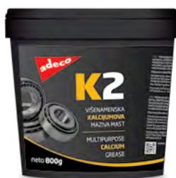
Vodootporna hidratisana kalcijumova mast proizvodi se u dve gradacije: NLGI 2 i NLGI 3. Koristiti se u temperaturnom rasponu od -25°C do 65°C. Preporučuje se za podmazivanje kotrljajući i klizni ležajevi, pumpi za vodu, klizni staze, zglobova, elektromotora, mašinski sklopova u svim industrijskim granama. Može se koristiti i za podmazivanje motornih vozila, građevinske i poljoprivredne mehanizacije i drugih transportnih sredstava.
